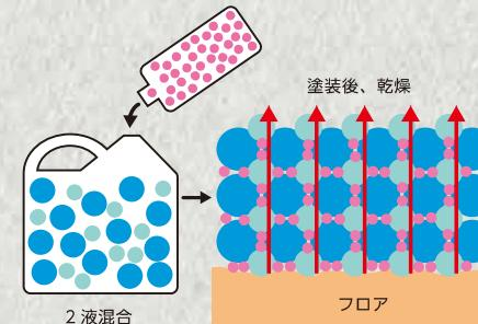
2液で混合した架橋剤微粒子の働きで、ポリマー粒子間の融着と強結合架橋（キュア）が同時に進行（シンクロ）し、急速に塗膜を緻密化。
