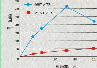
\*水を漏らしたMFワイドで拭取った後、60cmに切断して、1Lガラス瓶に入れ、ウレアーゼ酵素水を1ml垂らし、密封して時間経過ごとに検知管にてアンモニアの発生量を測定した。
