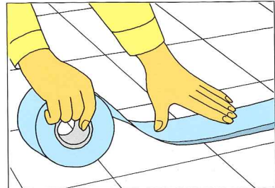
①作業エリアを養生する。
