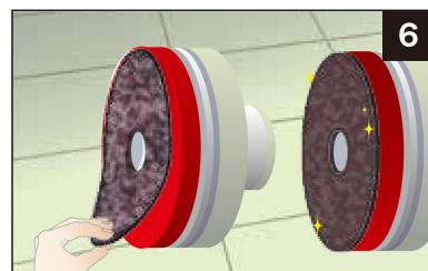
目詰まりによる洗浄力の減少を防ぐため、30m²前後作業したら裏返してご使用ください。広い面積を作業する場合は、数枚ご用意いただかく、パッドを洗浄しながら作業してください。
