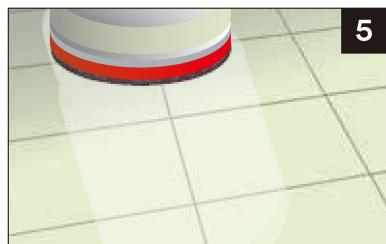
2回目は方向を変え、格子状に作業を進めてください。目安として、作業スピード8~12秒/m²でワックスが1層除去できます。
