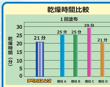
乾燥性の良い造膜助剤を配合することで塗膜の乾燥が速くなり、作業効率がアップします。
