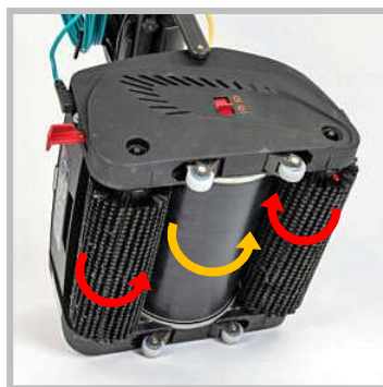
▲逆回転する 2本のブラシ が、汚れを遠心力で中心の ゴム製回転ドラム に吹き飛ばします。
